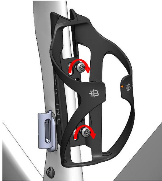
ケージを取り付け、M5ボルトをHex3で2 Nmのトルクで締め付けます。
