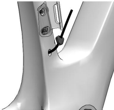
フロントディレイラーのDi2ケーブルをシートチューブの穴からボトムブラケットの出口ポートまで経路設定します。
